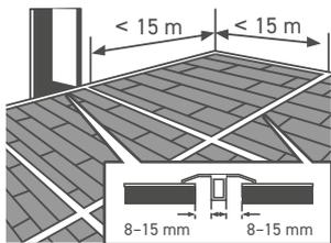
10.7 Обязательным является расширительный зазор не менее 8 мм между Art Vinyl Click и стеной по всему периметру помещения, а также между Art Vinyl Click и всеми неподвижными элементами (колонны, трубы, лестницы, камины, каменные (плиточные) полы, прикреплённые к полу предметы и т.п.).
