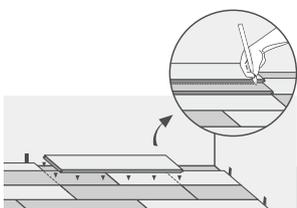
11.14 Укладка около труб. Отметить на планке карандашом место расположения центра трубы. Просверлить отверстие диаметром, превышающим диаметр трубы на 16 мм, для создания расширительного зазора вокруг трубы. Сделать пропилы под углом минимум 45° от края планки до просверленного отверстия. Вклеить отпиленный кусок, установив распорку между стеной и планкой и закрыть зазор вокруг трубы декоративным элементом («кольцом»).
