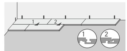
11.10.3 Зацепления продольного замка с предыдущим рядом осуществляется с правой стороны примерно на 2/3 длины планки. Для того чтобы завершить укладку, необходимо приподнять планки укладываемого ряда со стороны торцевого замка и лёгким постукиванием рукой и/или подбивочным брусом по продольной стороне сдвинуть планку до полного зацепления с предыдущим рядом.
